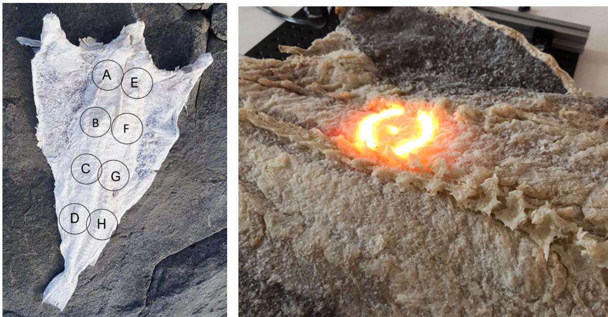
Figur 3. Målepunkter for hver fisk (venstre). Måling på ett målepunkt med GreenEye (høyre).
